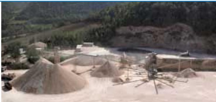
La prima parte del ciclo produttivo del calcestruzzo coincide con la fabbricazione del cemento. Le rimanenti fasi, che possono essere localizzate o meno nella stessa Unità Produttiva, sono la preparazione degli aggregati e la produzione finale del conglomerato cementizio.
