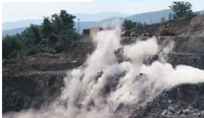
Per quanto riguarda le vibrazioni, provocate essenzialmente dallo sparo di mine o dall'esercizio di macchinari di perforazione, possono essere dannose se caratterizzate da frequenze prossime alla frequenza di risonanza delle strutture.
